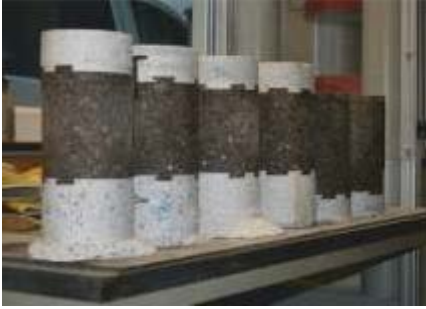
Prüfung der Verfüllergebnisse im Betonlabor
